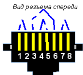
Рис. 10. Восьми-контактное гнездо и расположение пар (вид разъема спереди)
